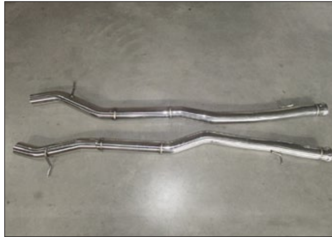
Exhaust middle pipes 223 221 139
